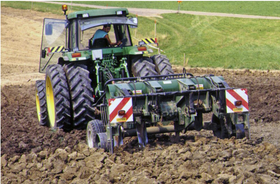
Abb. 40 &gt; Lockerung mit Spatenpflug
